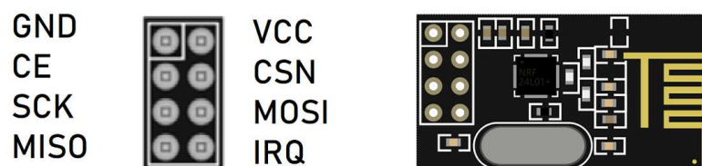
Obrázek 3.10: Rozložení pinů mikrokontroléru pro připojení periférií
