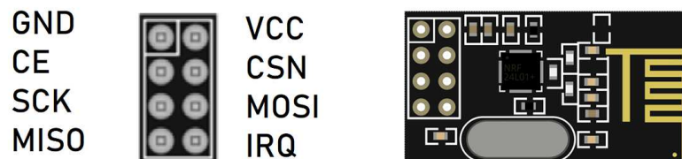
Obrázek 4.3: Rozložení vývodů komunikačního modulu (převzato z (HAGERSTEFAN.DE, 2022))
