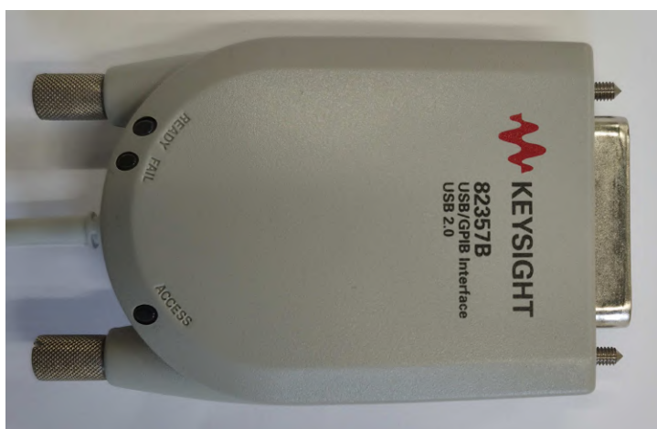
Obrázek 2.2: Komunikační rozhraní Keysight 82357B pro propojení řídicího počítače se sběrnici GPIB (IMS-2)
