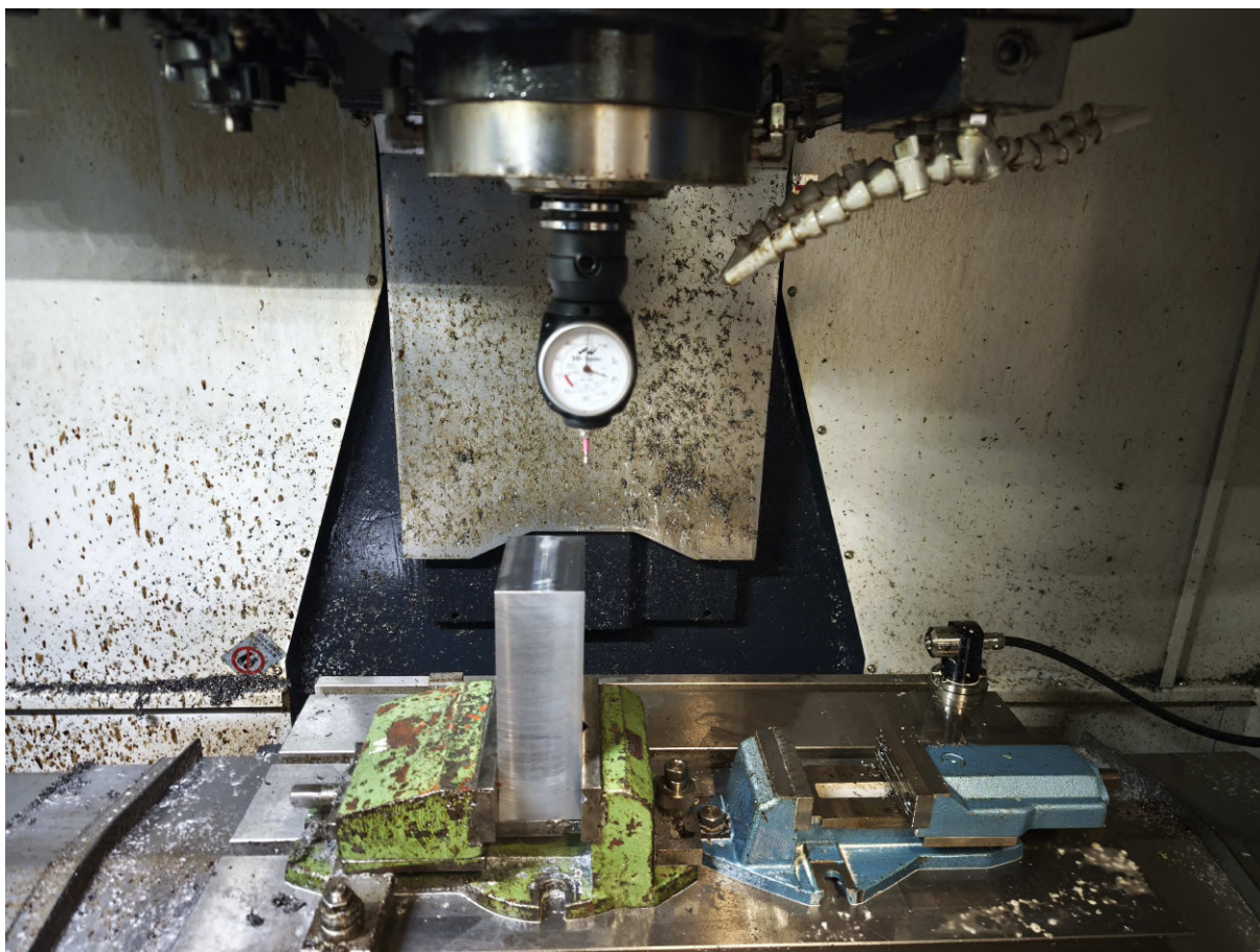
Obrázek 5.4: Nastavení nulového bodu
