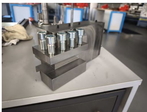
Obrázek 5.10: Složení jezdce s držákem
