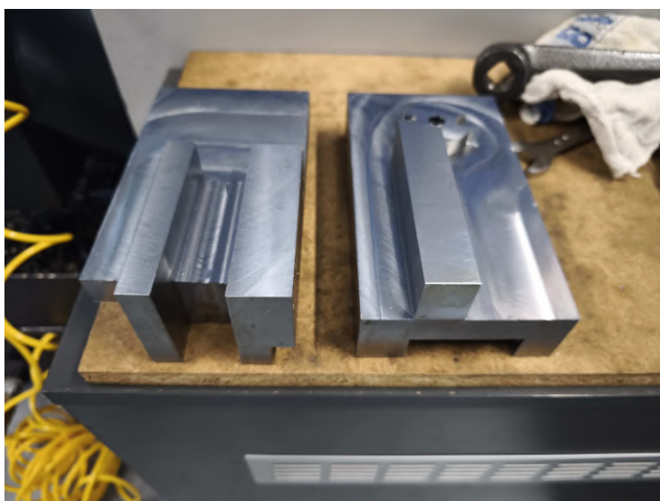
Obrázek 5.6: Obrobený jezdec a držák vedení
