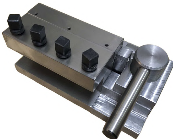
Obrázek 2.4: Přípravek závitového odskoku převzato z (KOVOOBRABEC, 2023)
