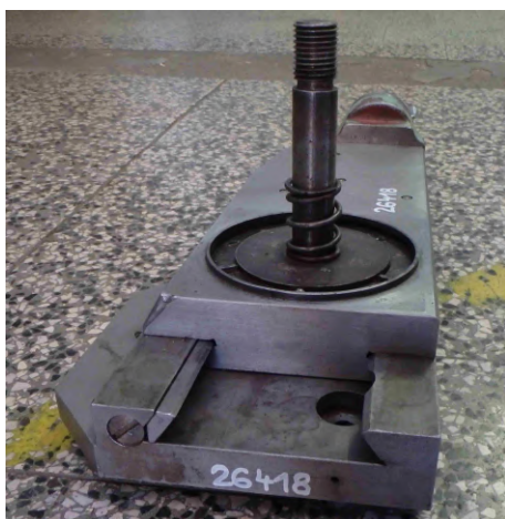
(a) Kluzné rybinové vedení převzato z (NASTROJENARADI, 2026)
