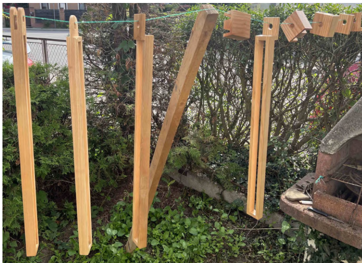
Obrázek 4.8: Nanesení vrstvy ochranného laku
