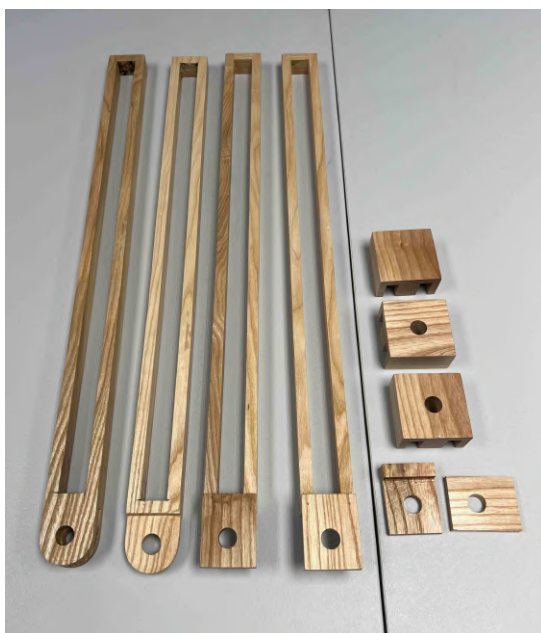
Obrázek 4.9: Kompletní sada dokončených dřevěných dílů optické lavice
