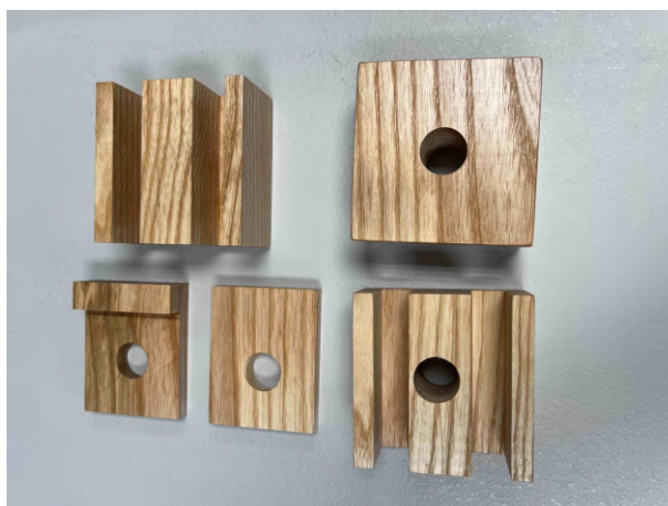
Obrázek 4.6: Detailní pohled na spodní frézování posuvných jezdceů
