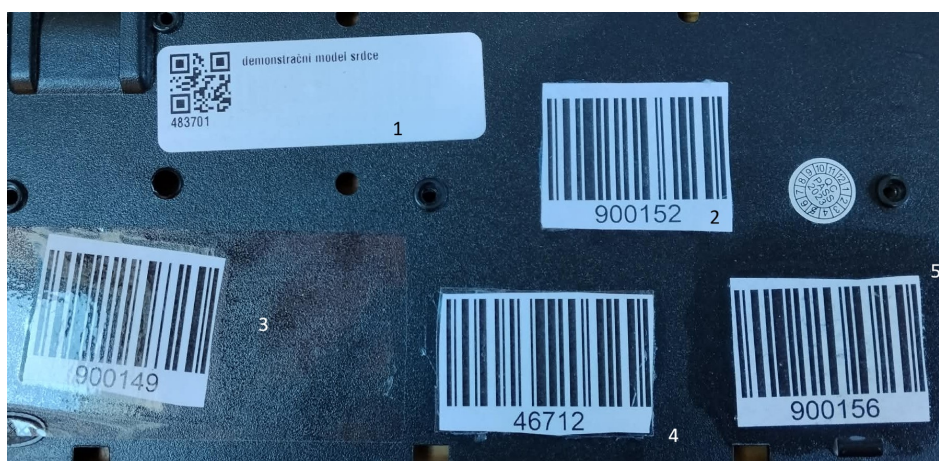
Obrázek 2.3: Ukázka nalepení kódů na plast
