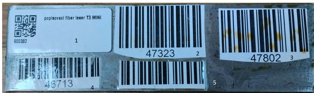
Obrázek 2.2: Ukázka nalepení kódů na kov
