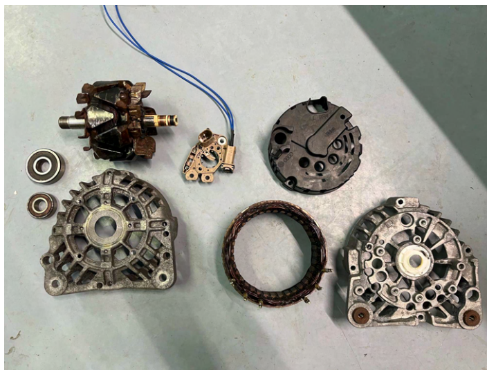
Obrázek 3.9: Díly rozebraného alternátoru
