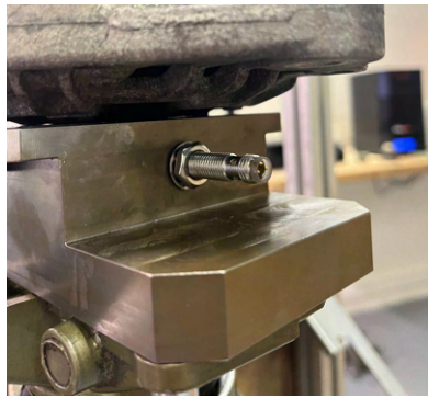
Obrázek 3.30: Montáž induktivního snímače Balluff
