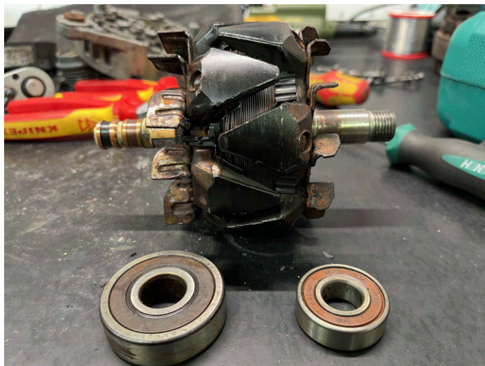
Obrázek 3.11: Ložiska a rotor alternátoru
