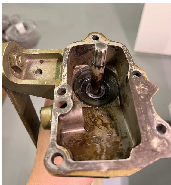
Obrázek 3.22: Vodící ložisko hřídele namontované
