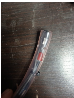
Obrázek 4.5: Navržená hladinoměrná sonda
