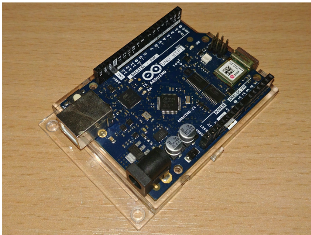
Obrázek 2.16: Arduino deska UNO WiFi REV2
