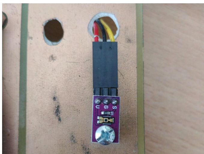
Obrázek 2.5: Snímač okolního osvětlení – pohled zepředu
