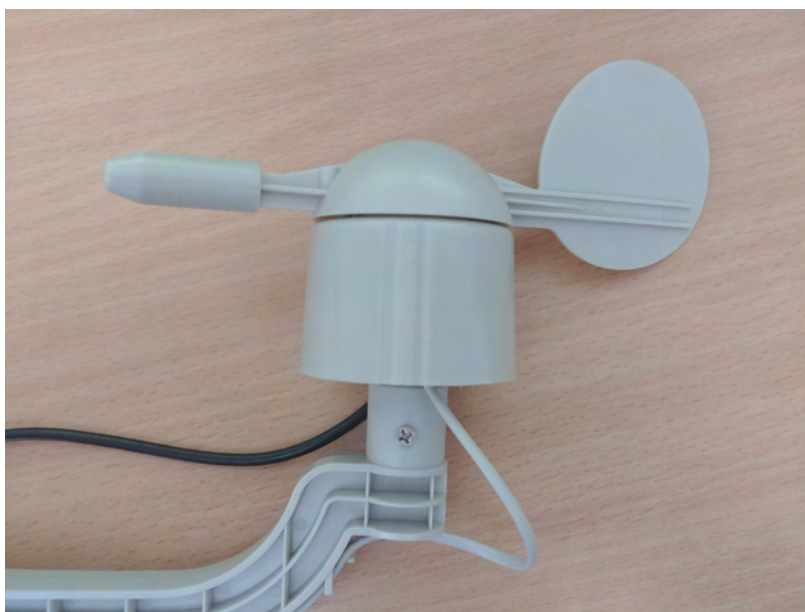
Obrázek 2.7: Snímač směru větru – pohled zepředu
