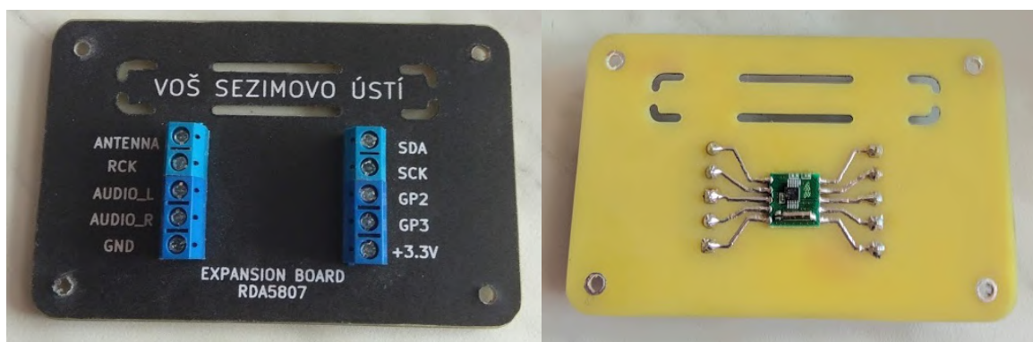
Obrázek 3.10: Expansion board RDA5807m – vlastní výroba
