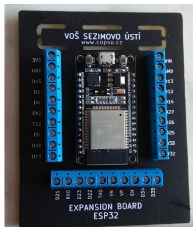
Obrázek 3.6: Rozšiřující deska pro ESP32 – vlastní výroba
