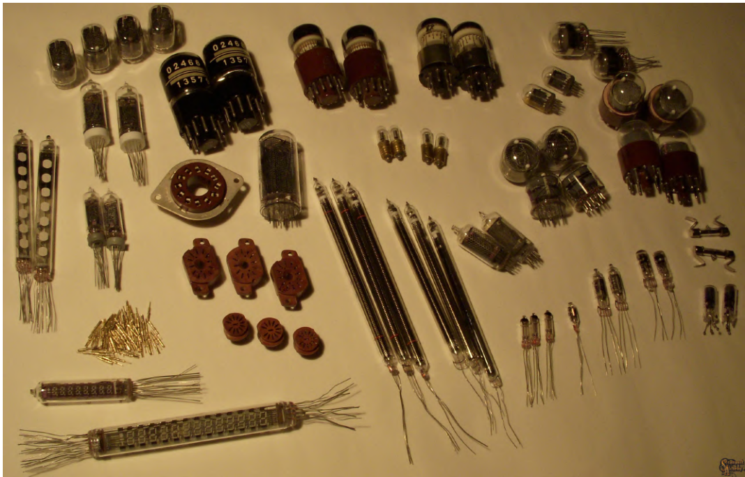
Obrázek 2.2: Různá konstrukční provedení retro zobrazovačů – dekadronů, digitronů, itronů a signálních doutnavek
