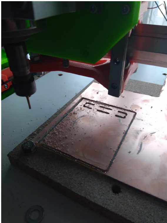
Obrázek 5.5: Frézování plošného spoje pro ESP32
