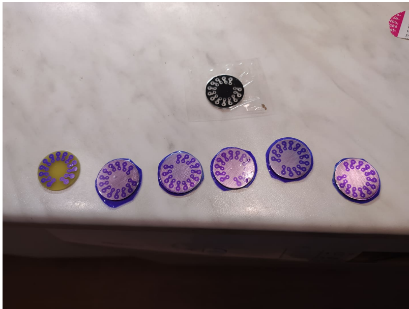
Obrázek 5.14: Připravené osvětlené plošné spoje
