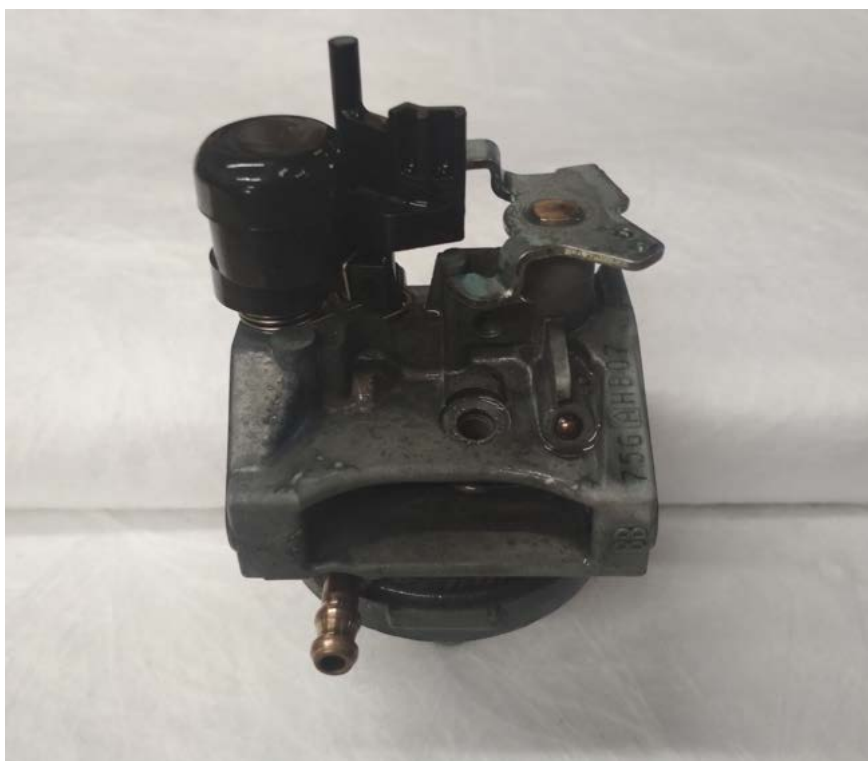
Obrázek 4.7: Karburátor vyjmutý z prototypu
