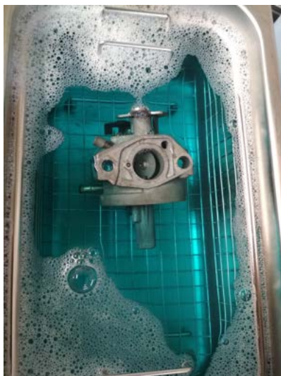
Obrázek 2.4: Karburátor v ultrazvukové lázni ENE-II-28-4L
