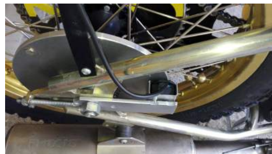
(b) Zadní snímač v detailu
