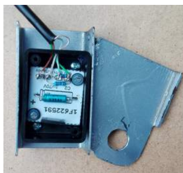
(b) Uložení snímače předního kola
