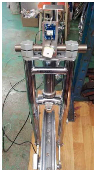
(b) Montáž GPS modulu
