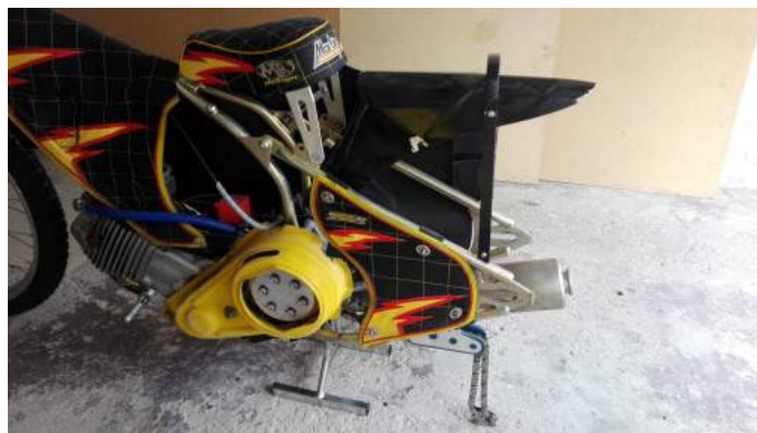
Obrázek 4.9: Demontáž zadního kola
