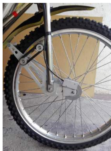
(b) Magnetický snímač na předním kole
