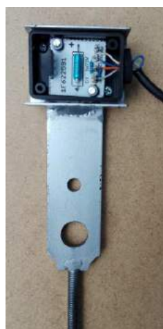
(a) Uložení snímače zadního kola
