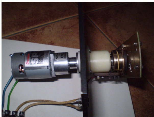
Obrázek 2.2: Způsob uchycení rotující a statické části.
