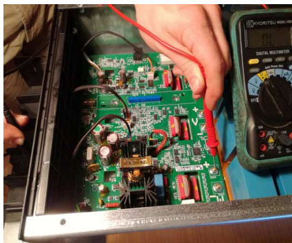
Obrázek 4.31: Měření IGBT + W
