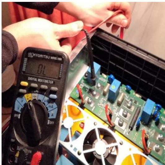
(a) První blok: Tyristor v propustném směru
