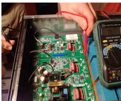
Obrázek 4.30: Měření IGBT + V
