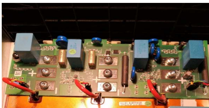
Obrázek 4.22: Usměrňovací část měniče
