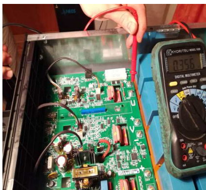
Obrázek 4.34: První blok: Zpětná dioda
