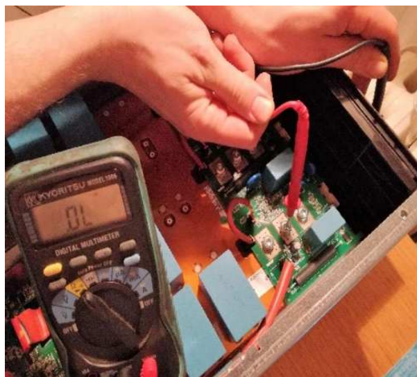
(c) Třetí blok: Tyristor v závěrném směru
