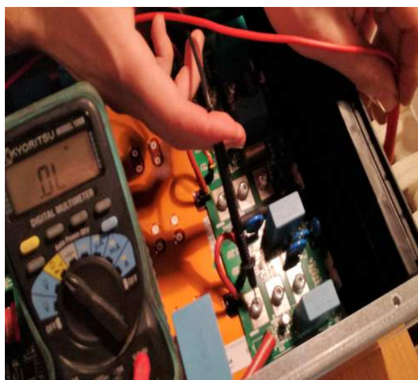
(c) Třetí blok: Dioda v závěrném směru
