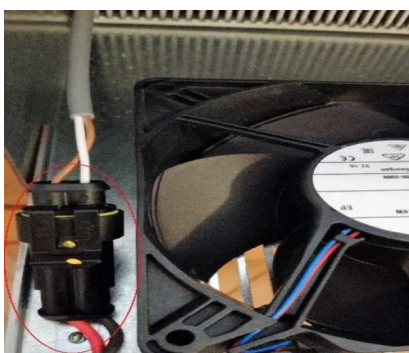
Obrázek 4.11: Výměna ventilátoru Neos: konektor
