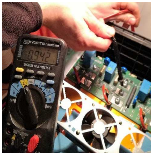
(b) Druhý blok: Tyristor v propustném směru
