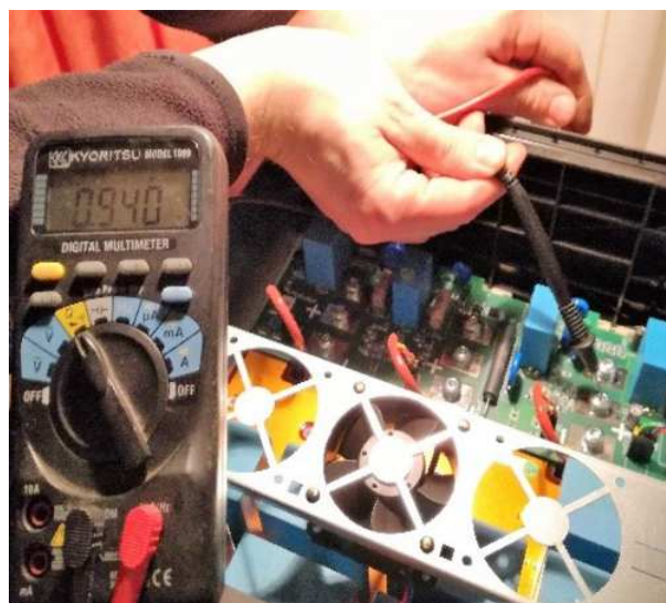
(c) Třetí blok: Tyristor v propustném směru
