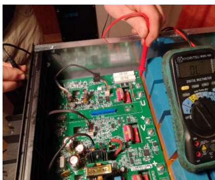
Obrázek 4.29: Měření IGBT + U
