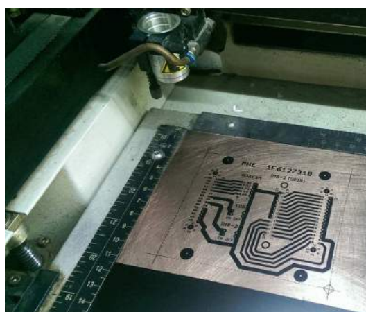
Obrázek 5.31: Vypalování DPS laserem Gravograph LS900
