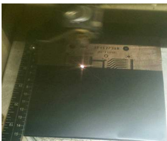
Obrázek 5.31: Vypalování DPS laserem Gravograph LS900
