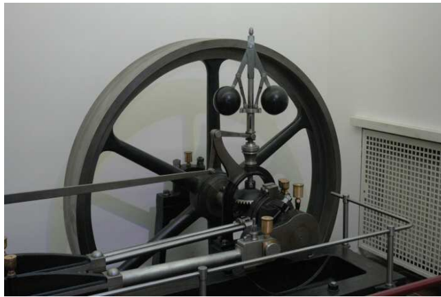
Obrázek 2.2: Regulace tlaku plynu pomocí Wattova odstředivého regulátoru – čerpáno z http://fyzika/jreichl.com
