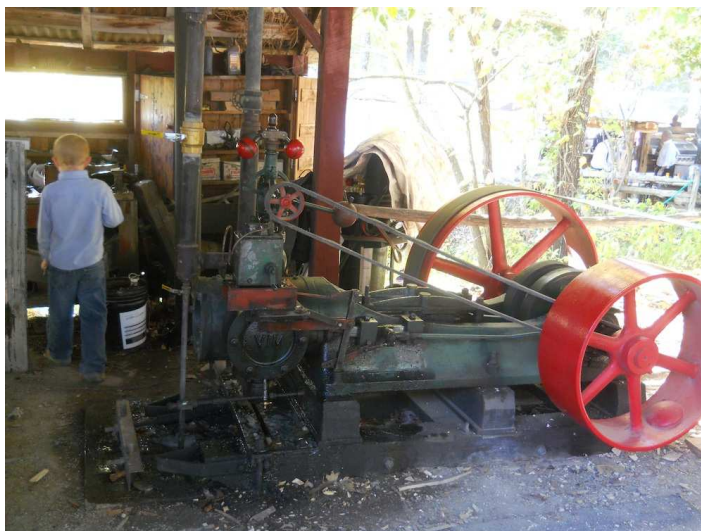
Obrázek 2.4: Použití Wattova odstředivého regulátoru pro řízení parního stroje – čerpáno z ( http://montessorimuddle.org/ )
