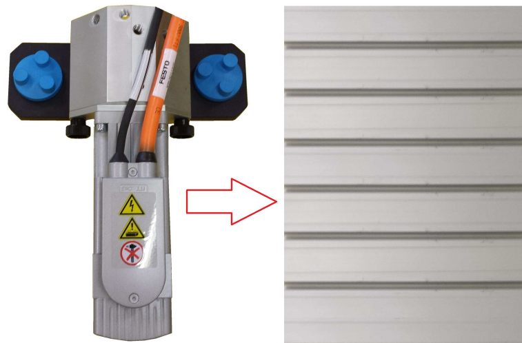
Obrázek 3.3: Připevnění servopohonu na drážkovanou desku
