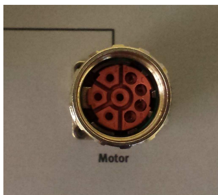
(b) Slot pro připojení napájecího kabelu
