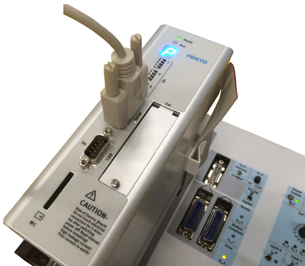
Obrázek 3.8: Připojení kabelu RS-232 k servoovladači CMMS-AS
