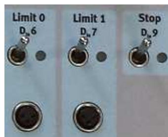
(c) Sloty pro připojení snímačů polohy Din6 a Din7
