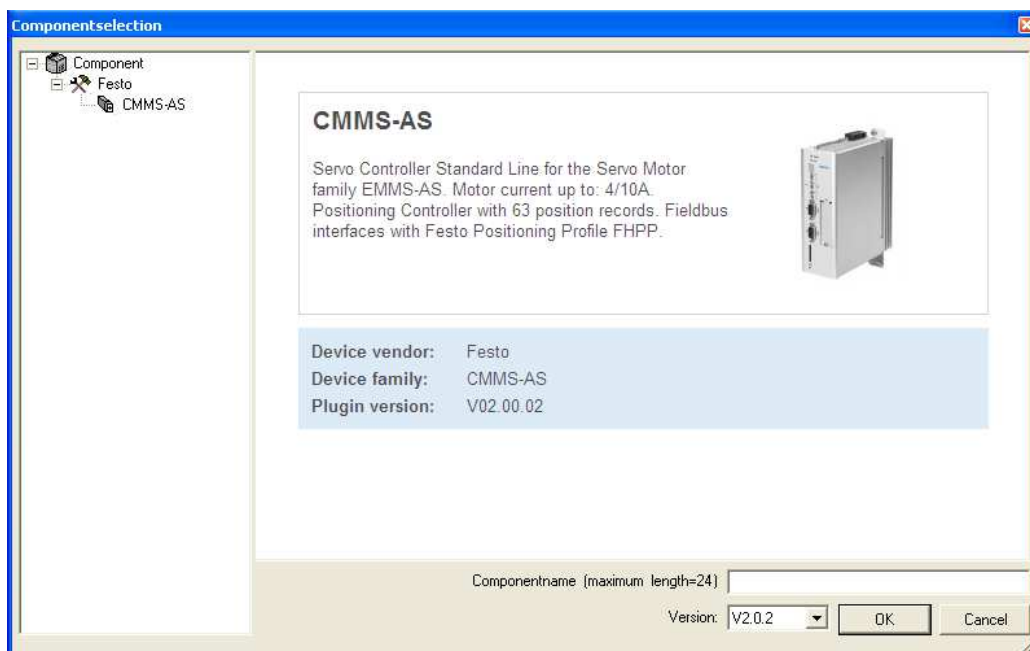
Obrázek 3.11: Definice názvu a verze servomotoru pomocí záložky Componentselection
