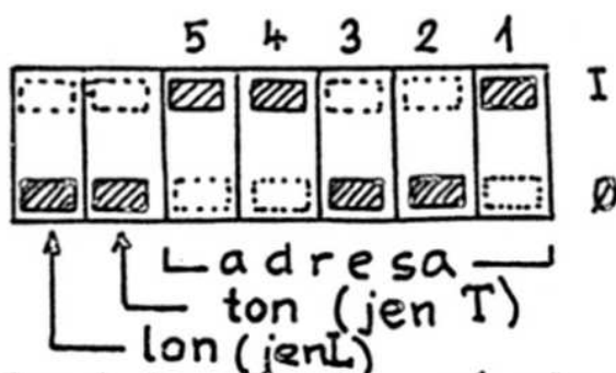
Obrázek 3.9: Nastavení adresy přepínačem DIL
