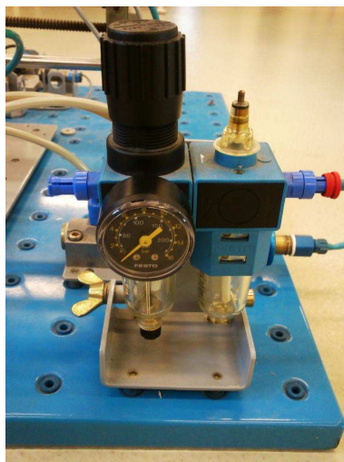
Obrázek 2.1: Stanice čištění s regulací tlaku
