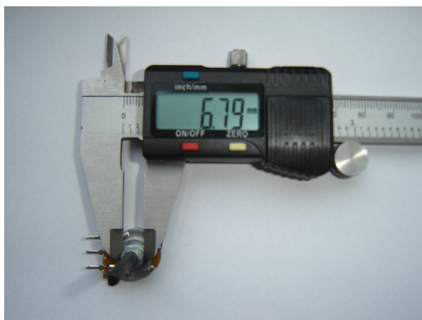
Obrázek 4.4: Přeměření rozměru potenciometru
