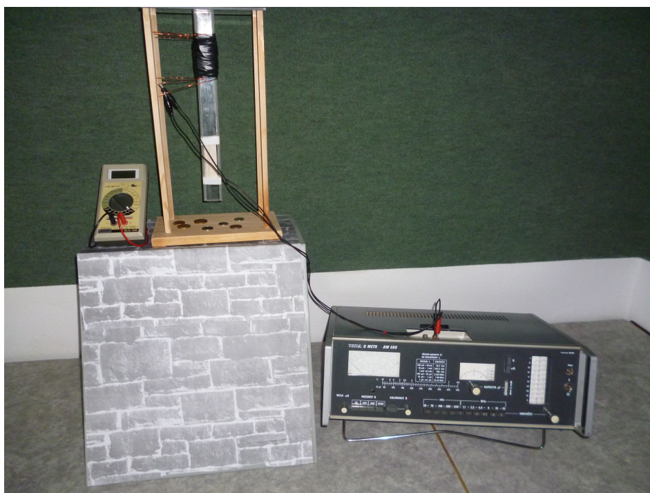
Obr. 47: Finální měření jakosti a indukčnosti
