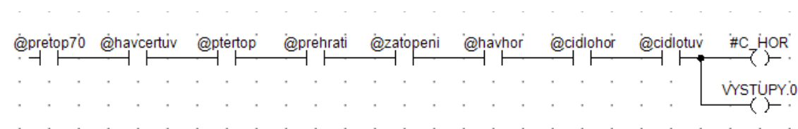
Obr. 25 Poruchy ovlivňující chod čerpadla na horkovodu
