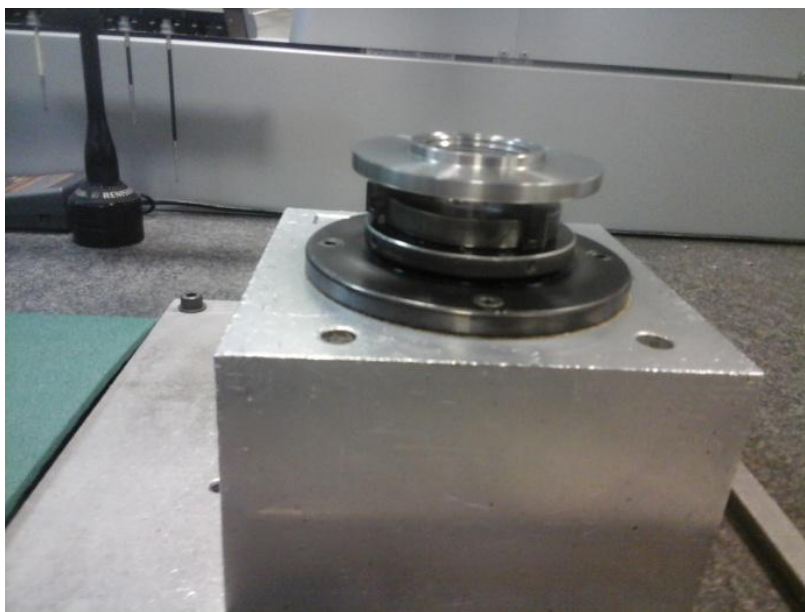
Obr. 3.3 – Upnutí a uložení komponentu v CMM
