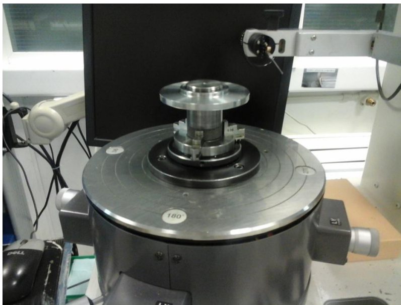
Obr. 3.5 – Upnutí komponentu v kruhoměr
