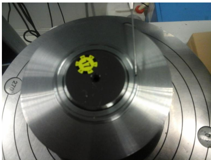
Obr.3.6 – Měření rovinnosti na podpurné ploše
