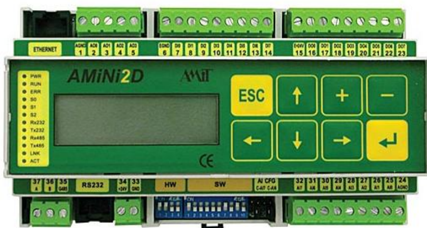
Obrázek 2.3.1: Programovatelný automat AMiNI2D (převzato z [08])
