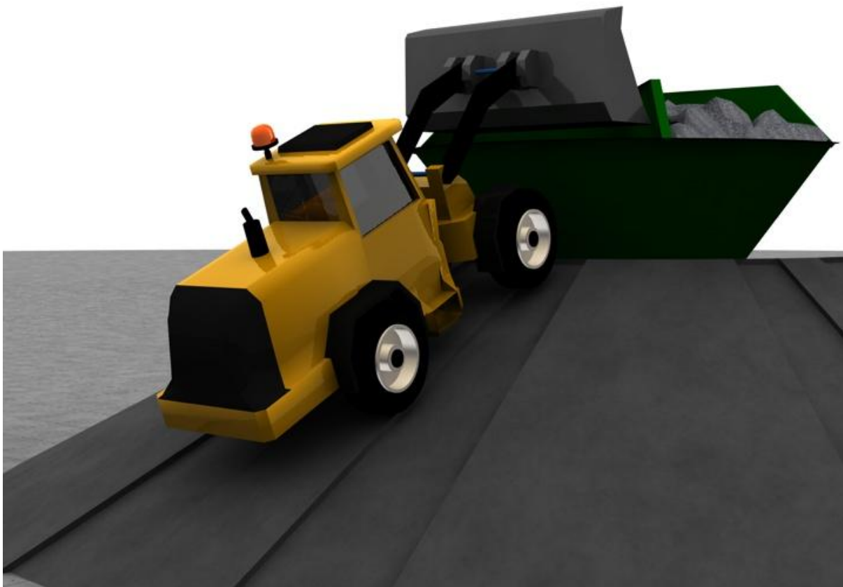
Obrázek 4. 4: Kolový čelní nakladač naváží kamenivo do vějířového zásobníku
