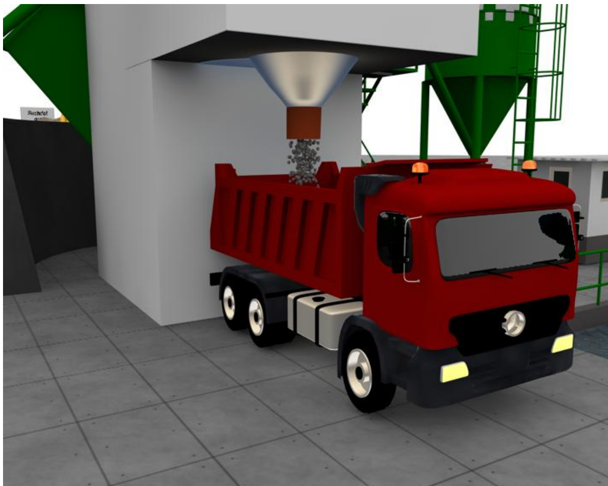
Obrázek 4.13: Výdej čerstvého betonu
