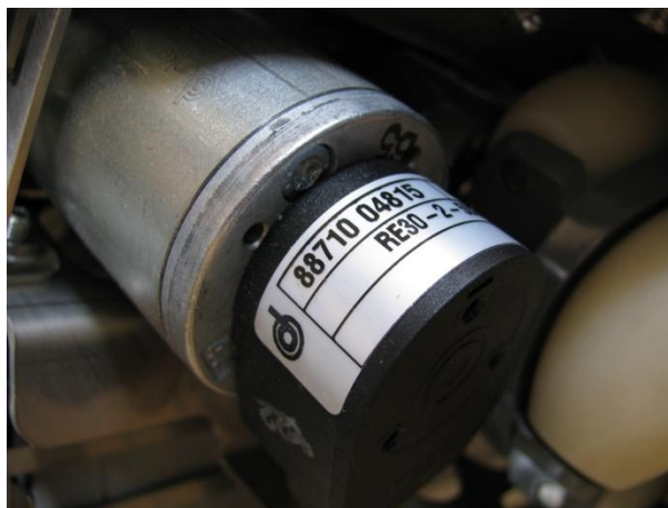
Obrázek 3.1: Optický inkrementální snímač
