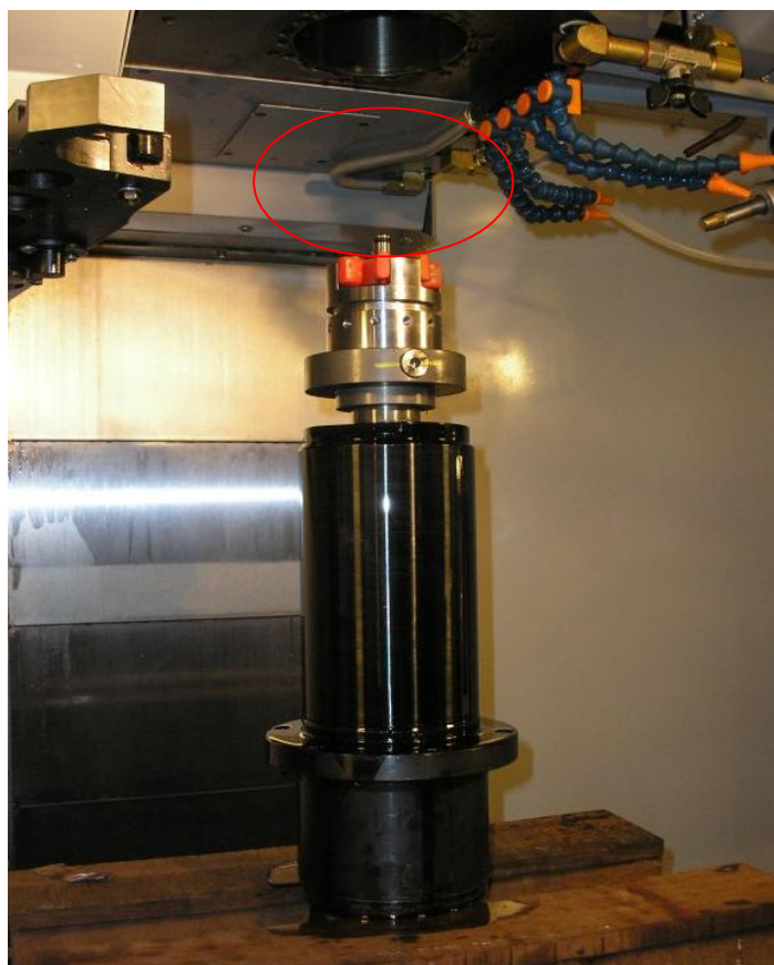
Obr. 10: Znázornění plastové spojky pro spřažení ve vřeteníku
