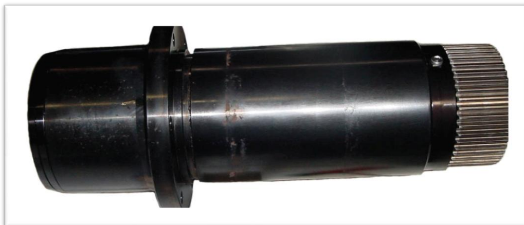
Obr. 6: Typ vřetene s řemenicí určené pro spřažení s náhonem přes řemeny
