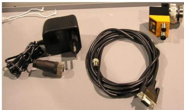
Obr. 24: Sestava OCTAVIS = čidlo, sériové rozhraní RS - 232, napájení čidla
