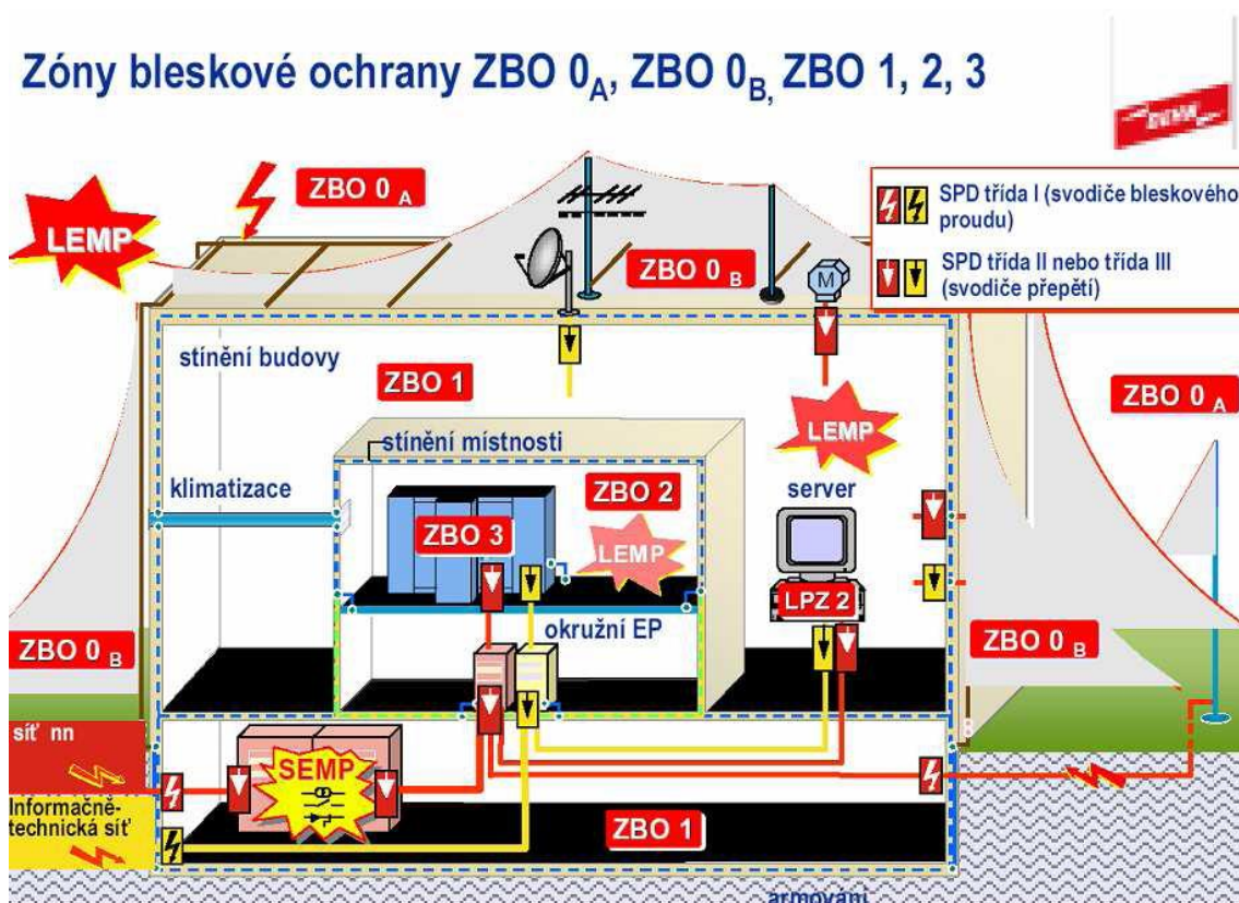
obr. 6 rozdělení zón bleskové ochrany ZBO (LPS)
