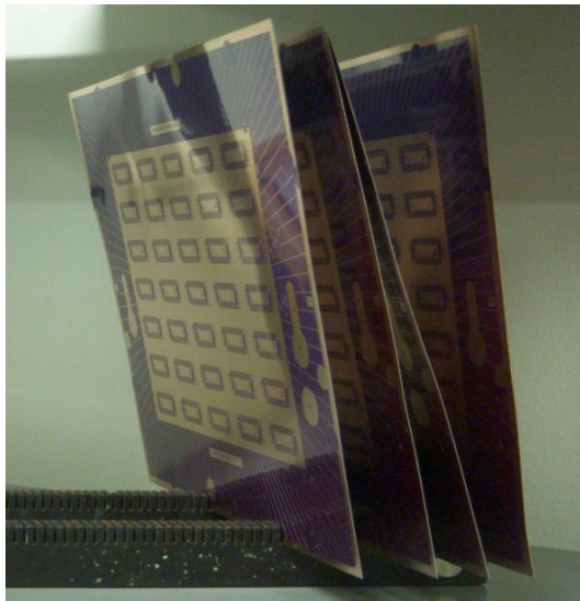
Obr. 14: Vyvolané vnitřní vrstvy před leptáním.
