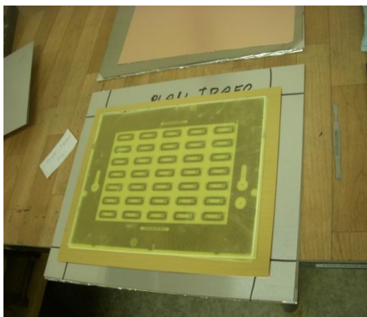
Obr. 22: Skládání paketu pro vakuový lis.
