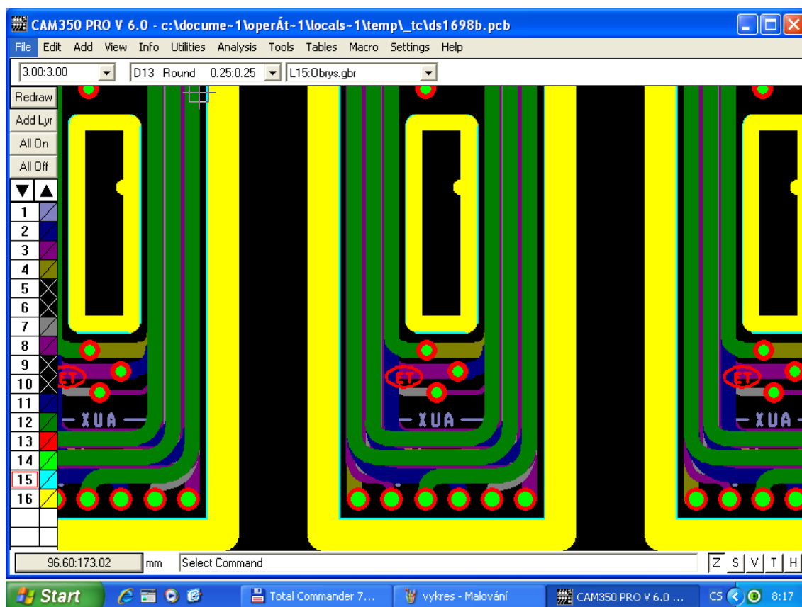
Obr. 10: Práce na skládání jednotlivých vrstev v programu CAM 350 V 6.0.
