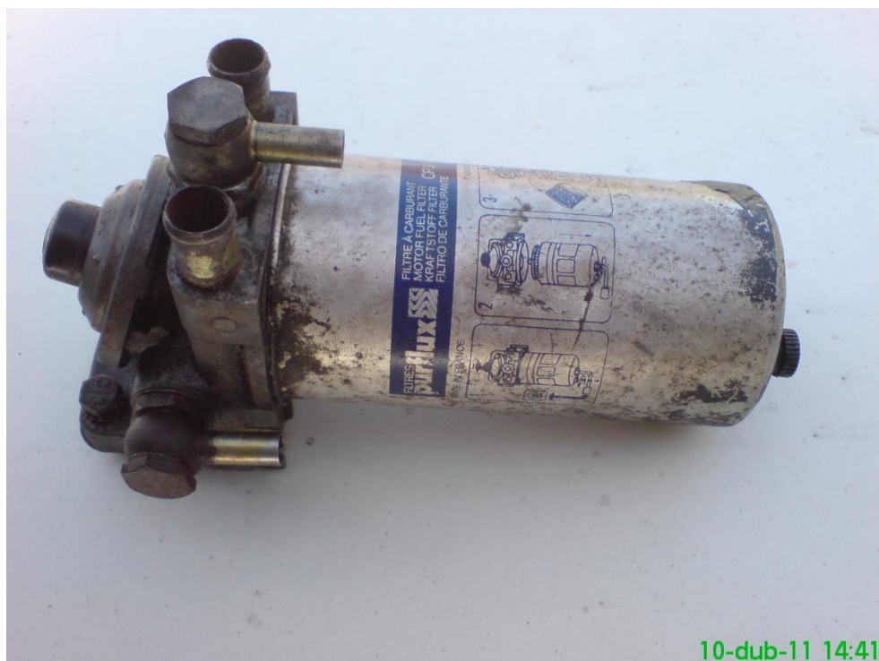
Obrázek 27, palivový filtr vyhříváný vodou (Peugeot 205, 1.8D, r.v. 1986)
