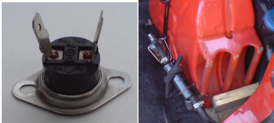
Obrázek 29, bimetalový termostat 45°C; vpravo palivová nádrž
