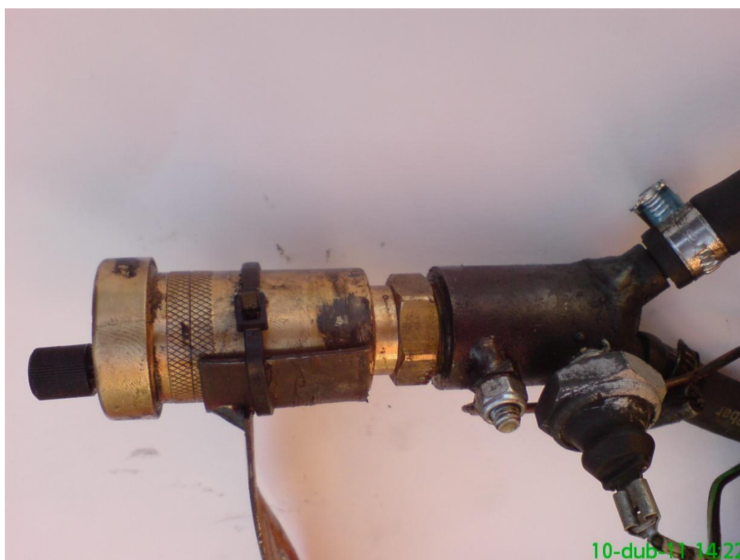
Obrázek 25, umístění ovládacích spínačů (manuální ovládání)
