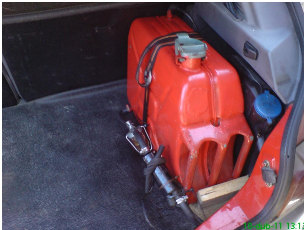
Obrázek 8, umístění palivové nádrže v zavazadlovém prostoru
