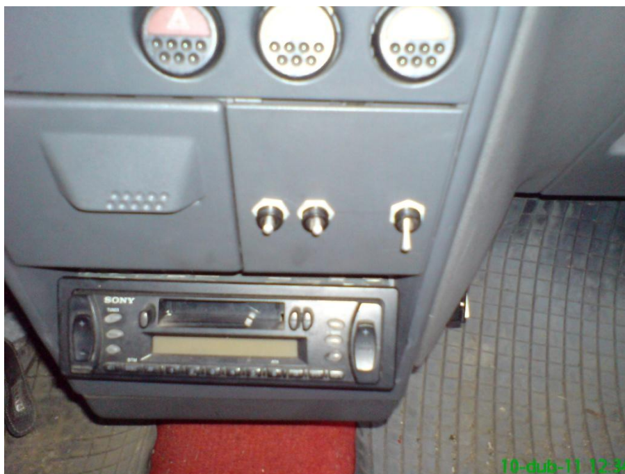
Obrázek 25, umístění ovládacích spínačů (manuální ovládání)
