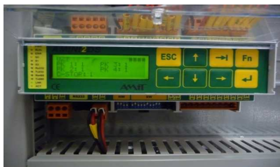
Obr. 30 Zobrazení již zapojeného ŘS AMiNi2DS
