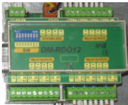
Obr. 14 Rozšiřující prvek DM-RDO12 přímo ze zapojeného systému
